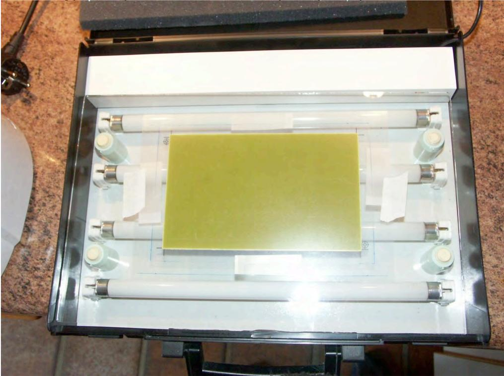
On voit bien le rôle des traits de coupe et la facilité de positionnement dûe au fait que le CI est 2 à 3 mm plus grand que le typon ! Fixer le CI avec du scotch papier.
